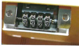
找到4条密码轮的缺口位置对齐。 Make sure 4 grooves be in line.
